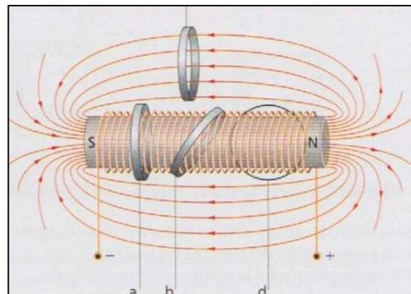
A der Fläche und ihrer Orientierung zu den Feldlinien. Die wirksame Fläche kann durch einen Flächenvektor  $A$  beschrieben werden, der senkrecht zur Fläche  $A$  steht und dessen Betrag den Flächeninhalt  $A_s$  beschreibt. Der Winkel  $\alpha$  zwischen dem Vektor der magnetischen Flussdichte  $B$  und dem Vektor  $A$  gibt die relative Orientierung an. Es gilt:
